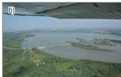
14. ábra – A C-variáns és fő létesítményeinek elrendezése (a). A dunacsúnyi duzzasztómű (b) azért épült, hogy a Dunakiliti duzzasztómű (c) helyett az terelje a vizet az Öreg-Dunából a bósi vízerőmű (d) felé.
