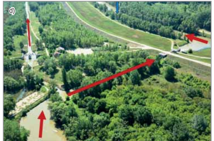
28. ábra – (a) Rajkai-zsilip 1991-ben; (b) Mosonmagyaróvári duzzasztómű 2025-ben; (c) a Mosoni-Duna vízkivételi mű és tápcsatorna a dunacsúnyi tározónál; (d) vízáramlás a tápcsatornában, ahol a Kertész-gát jobbra, a rajkai vízkivételi zsilip felé, majd azon át – az árvízvédelmi töltést keresztezve – a Szivárgó-csatornába juttatja a Mosoni-Duna vizét
