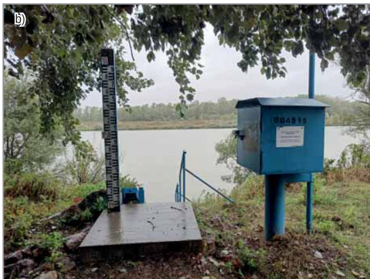
30. ábra – Szigetközi felszíni vízszintmérő állomások elhelyezkedése. A vízrajzi állomások olyan mérőhelyek, ahol a folyó vagy csatorna vízszintjét rendszeresen vagy folyamatosan mérik a hosszú távú változások követésére (Szűcs, 2018) (a); az Öreg-Duna doborgási – távmérővel felszerelt – vízmerceje (b)
